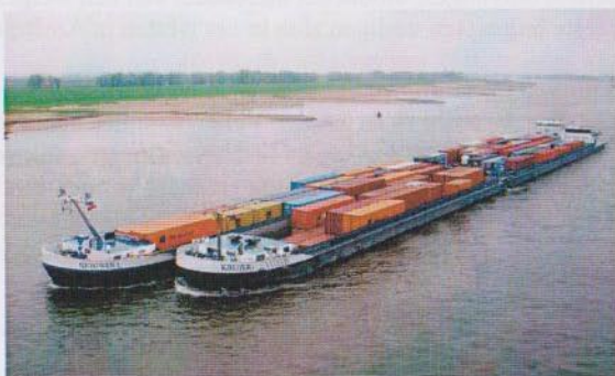
Duidelijk is de deling in het midden van de twee scheepsdelen te zien.
